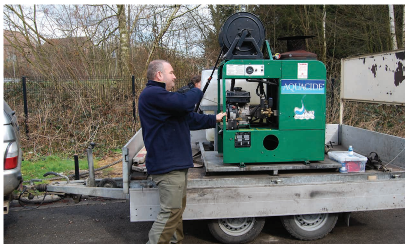
Machine désherbeuse thermique - ©CRSenne
